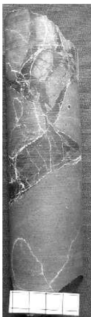
92. kép. A Szarvaskői Bazalt feltöredezett és a bezáró fekete palával összekeveredett bázisa. Szk-45 fúrás, 197,3 m Photo 92. Fragmented basal part of the Szarvaskő Basalt mixed with the black shale (host rock). Borehole Szk-45, 197.3 m.
