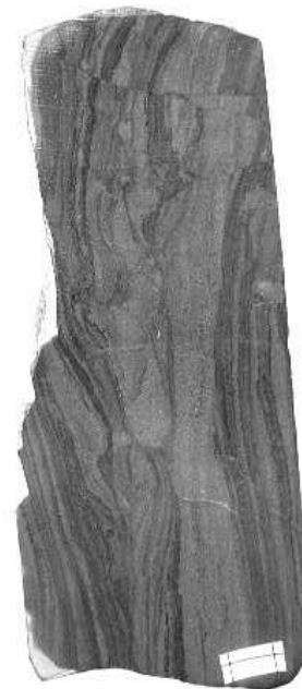
84. kép. Iszapcsúszásos szerkezetű, függőleges állású homokkőrétegek (Vaskapui Homokkő Formáció). Szk-48 fúrás, 41,0 m
