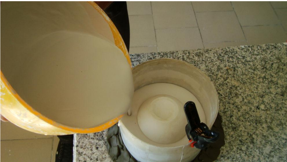
A magmodell leöntése egy irányból
