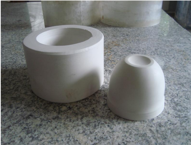
Száradás után a negatívából a magmodell kivehető
