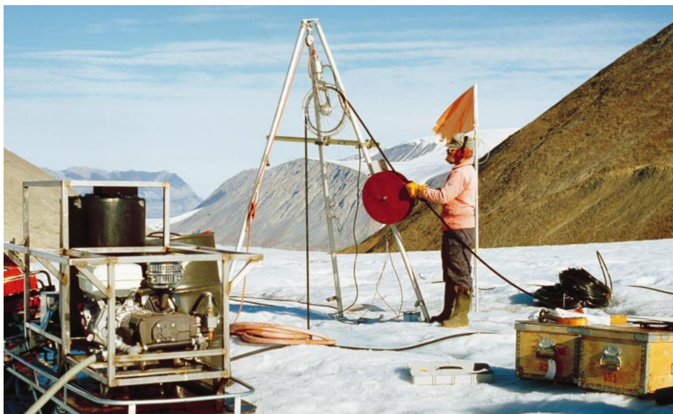
Figur 10. Varmtvandsboring på gletschertunge, der flyder ud fra Hans Tausen Iskappe.
