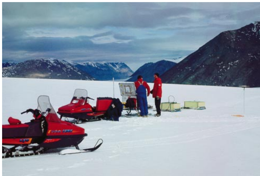
Figur 6. Radarmålinger på overfladen af Hans Tausen Iskappe. Antennerne er monteret i de små gule kasser med meder.
