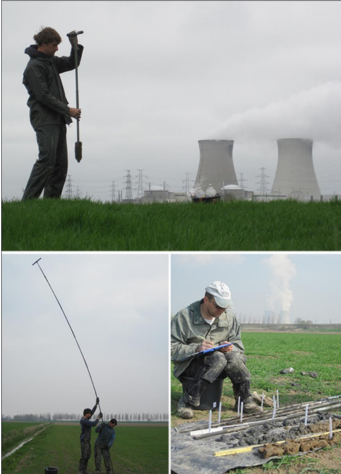
Figuur 4-6 Sfeeropname van het booronderzoek gebruikmakend van Edelmanboren (boven), gutsboren (onder, links) en een gedetailleerde bodemkundige registratie van de boorkolommen (onder, rechts).
