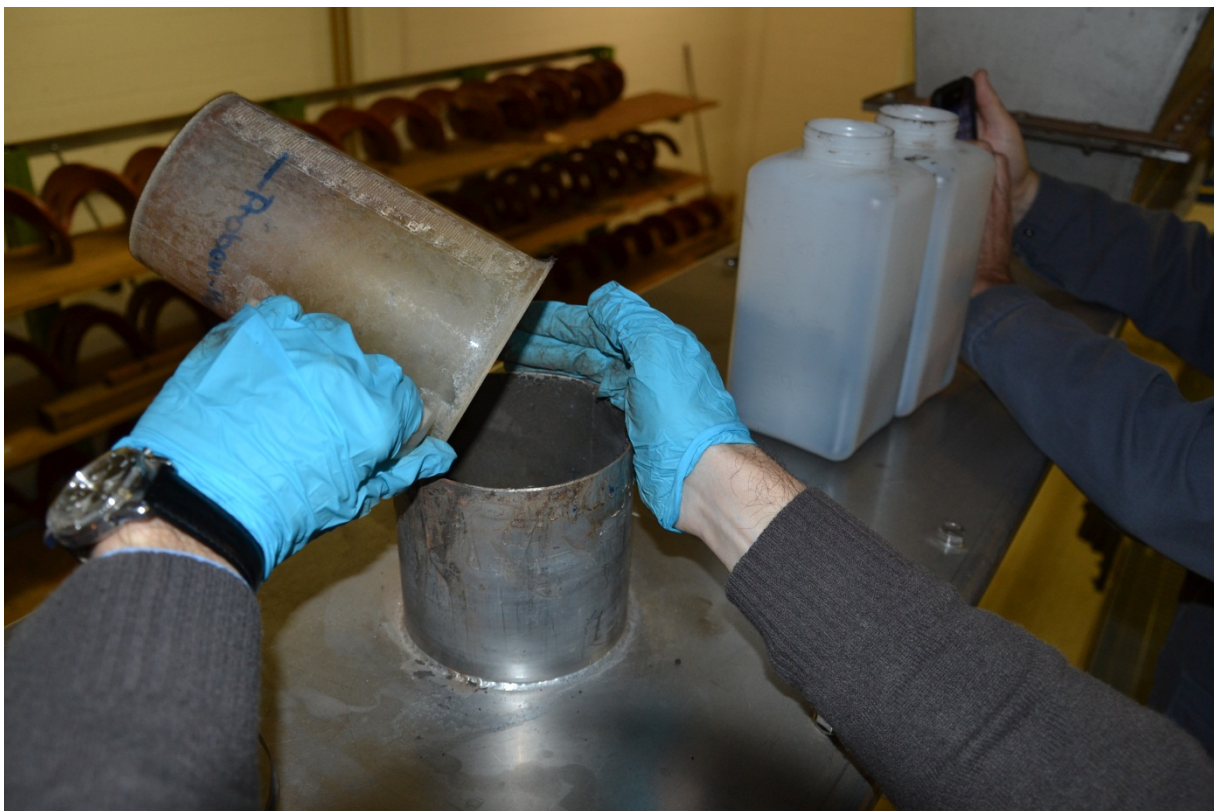
Abbildung 41: Manuelle HTC-Kohlezudosierung bei der SVA Winterthur (Kläusli, 2013)
