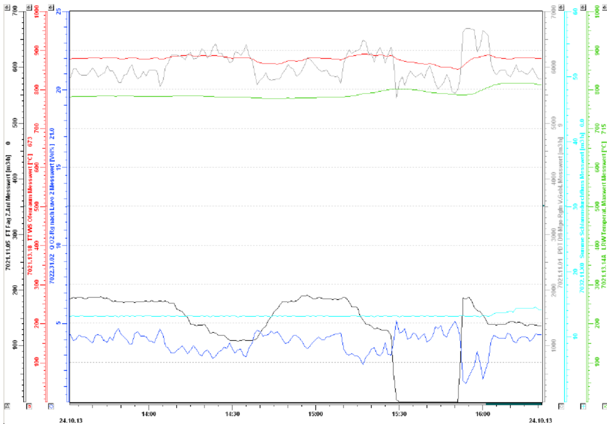
Abbildung 49: Verlauf der Ofentemperatur („rote“ Kurve; in °C) sowie der benötigten Zusatzbrennstoffmenge („schwarze“ Kurve; in m 3 /h) im Versuchszeitraum von Versuch 2 (SVA Winterthur, 24. Oktober 2013)
