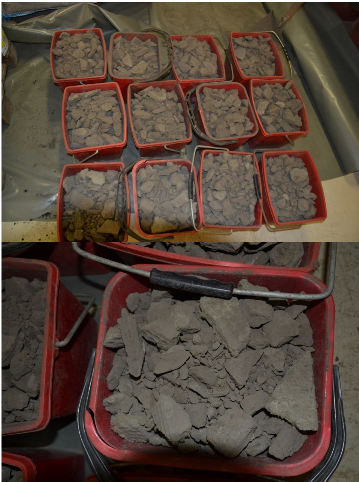
Abbildung 46: Verwendete Füllbehälter sowie Struktur der bei der SVA Winterthur verwendeten HTC-Kohle (Kläusli, Oktober 2013)
