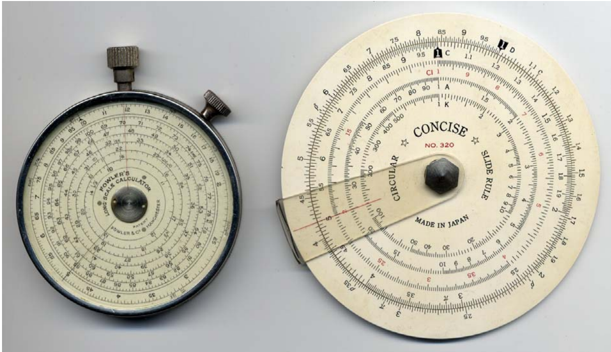
Kuva 10. Kaksi laskukiekkoa. Isommassa Concise kiekossa on uloimman asteikon halkaisija 8 cm ja siinä on D, C, CI, A ja K asteikot. Concise valmistaa edelleenkin laskukiekkoja, ks. www.concise.co.jp/eng0731/top_eng.html . Fowler kiekon uloimman asteikon halkaisija on 6 cm ja siinä on sisempänä 6 osiin jaettua asteikkoa, joiden yhteispituudeksi tulee 76 cm. Kummassakin on laskettuna kuvan 2 kertolasku ja kiekolla saadaan myös 1,19 kerrottuna välillä [8,4, 10] olevilla tekijöillä toisin kuin varsinaisilla laskutikuilla.
