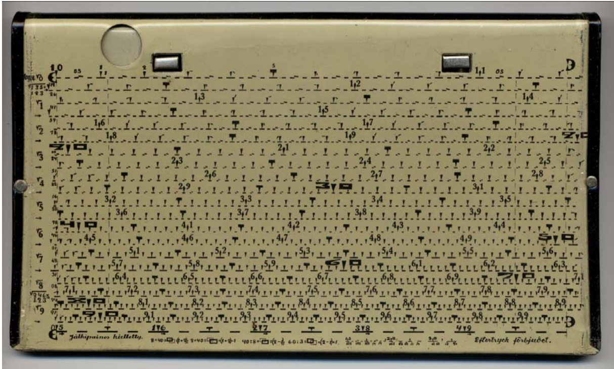
Kuva 12. Halikkolaisen agronomi Eino Veitsolan suunnittelema kotimainen grid-iron laskulevy vuodelta 1933, om. Jyrki Raulo. Tässä on logaritminen asteikko välillä [1, 10] jaettu kahteenkymmeneen 17,5 cm pitkään osaan, joten asteikon kokonaispituus on 350 cm ja saavutettu laskutarkkuus tekijän mukaan huolellisella asettelulla yksi seitsemästuhannesosa ts. lähes neljä numeroa. Turun pussi ja kirjjekuoritehtaassa painetun asteikon jaotus on varsin omaperäinen.
