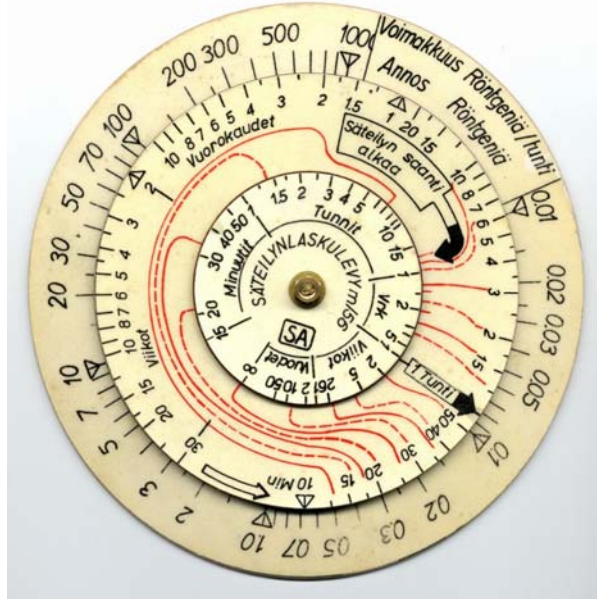
Kuva 25. Suomen armeijan säteilylaskukiekkö m/56, vaneria. Uloimman asteikon halkaisija 11,8 cm ja käyttöohje on takapuolella. Laite on ilmeisesti amerikkalaisen Radiac kiekkö jökseenkin suora kopio.
