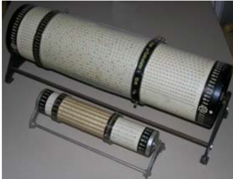
Kuva 13. Kaksi sveitsiläistä Loga laskurumpua. Suuremmissa on 60 kappaletta 60 cm pituisia asteikonpätkiä, mutta asteikon kokonaispituus on käyttöä helpottavista päällekkäisyyksistä johtuen "vain" 15 m. Pienemmässä rummussa puolestaan on 20 kpl 24 cm pituisia asteikkoja ja asteikon kokonaispituus 2,4 m.
