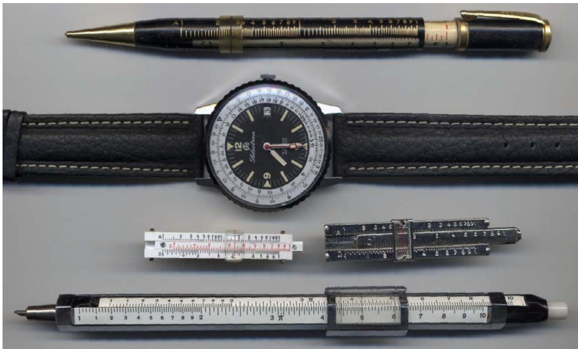
Kuva 16. Muovinen (asteikot A, C, D: pituus 3,6 cm) ja hopeinen (asteikot A, C, D: pituus 4,1 cm) solmioneulalaskutikku, kaksi kynälaskutikkua (ylemmässä asteikot K, A, B, C, C, D: pituus 7,3 cm ja alemmassa A, B, C, D: pituus 12,5 cm) sekä rannekelloon ympätty laskukiekkoo (asteikon pituus 10 cm). Alemmassa kynälaskutikussa on suoritettuna kuvan 2 kertolasku.
