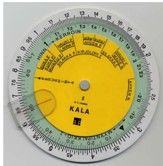
Kuva 27. Kalojen hinnoittelukiekkö, muovia, uloimman asteikon halkaisija 10 cm. Takapuolella on tavalliset logaritmiasteikot kerto- ja jakolaskua varten.
