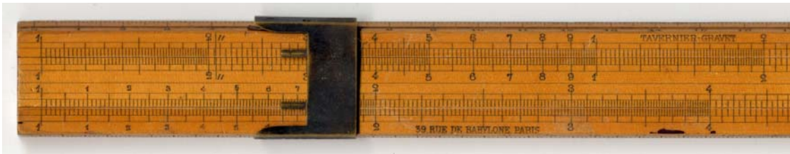
Kuva 4. Puksipuinen, Tavernierin ja Gravetin noin vuonna 1875 valmistama Mannheim laskutikku, asteikon pituus 25 cm. Vanhanmallisessa hahlossa ei vielä ole käytössä lasia. Näkyvissä on ylhäältä lukien A, B, C ja D asteikot. Lisäksi kielen takapinnalla on siniasteikko S, tangenttiasteikko T ja logaritmiasteikko L. Asteikkoja on siis yhteensä 7.
