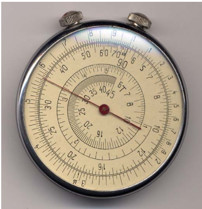
Kuva 11. Spiraalinmuotoinen asteikko venäläisessä КЛ-1 (KL-1) laskukiekkossa, jossa uloimman logaritmisin asteikon halkaisija 3,7 cm. Sen sisäpuolella on siniasteikko normaaliin tapaan välillä [5°44', 90°]. Tangenttiasteikko kiertää nyt spiraalina lähes kaksi kierrosta, joten siihen on saatu mahtumaan kulmien [1°, 45°] tangentit. Kuvassa on määrätty \tan 30^\circ = \cot 60^\circ \approx 0,577 .
