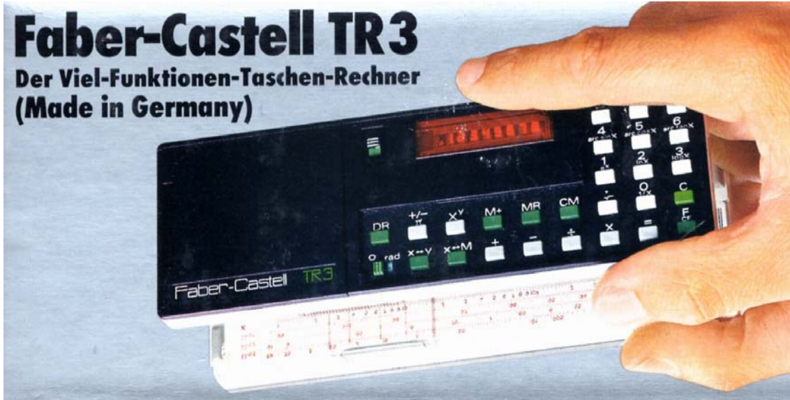
Kuva 9. Faber-Castell TR3 laskutikku, jonka takapuolella on elektronilaskin, asteikon pituus 12,5 cm. Tämän mallin laskin on peräti tieteilaslaskin. Punainen LED näyttö tosin kuluttaa niin paljon virtaa, että laskutikkupuolta on tarvittu ainakin akun latauksen loppuessa.
