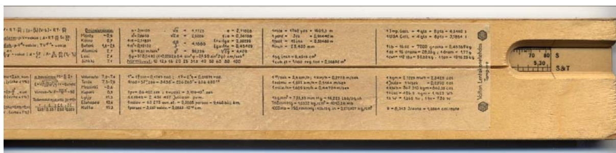
Kuva 22. Valtion Lentokonetehtaan Rietz laskutikun kääntöpuoli, asteikon pituus 25 cm.
