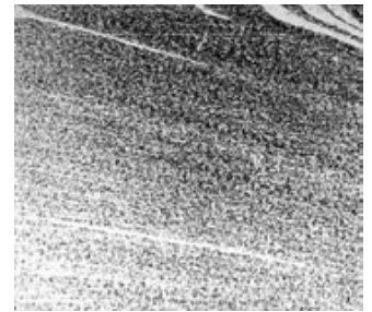
Kontermaterial nach Scheuertest
