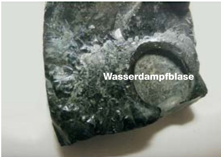
Bild 10 Treibofenglätte mit Wasser abgelöscht
