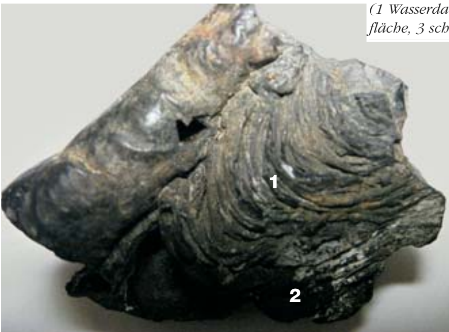
Bild 8 Flammofenschlacke mit Fließfiguren. Leichtflüssige Schlacke (1 enge Fältelung, 2 glasiger Bruch)
