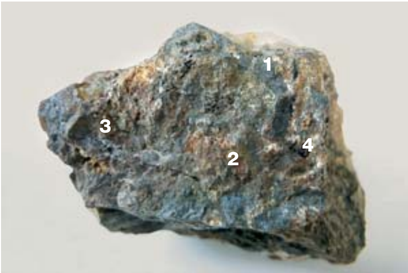
Bild 1 S-charler Erz, bestehend aus feinkristallinem silberhaltigen Bleiglanz (1), Limonit (2), Zinkblende (3) und Baryt (4)
