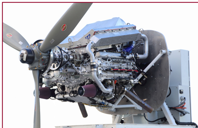
Under 2015, började luftfartsmyndigheten Federal Aviation Authority, att godkänna den första flygmotorn med motorblock i CGI åt Engineered Propulsion Systems (med tillstånd av EPS, Inc.)
