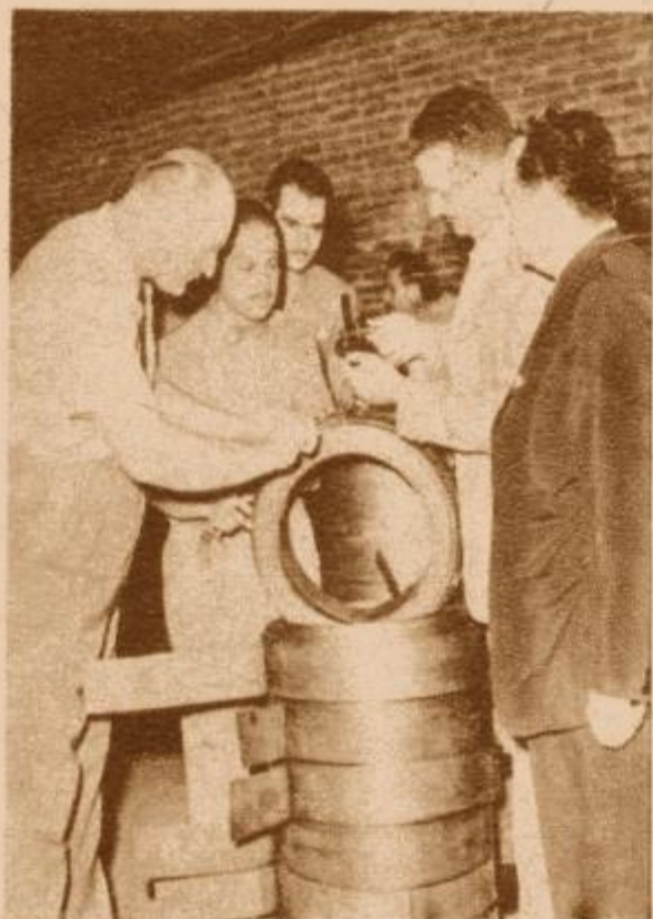
PERSONAL ESPECIALIZADO del establecimiento, controla los anchos y espesores del fleje.
