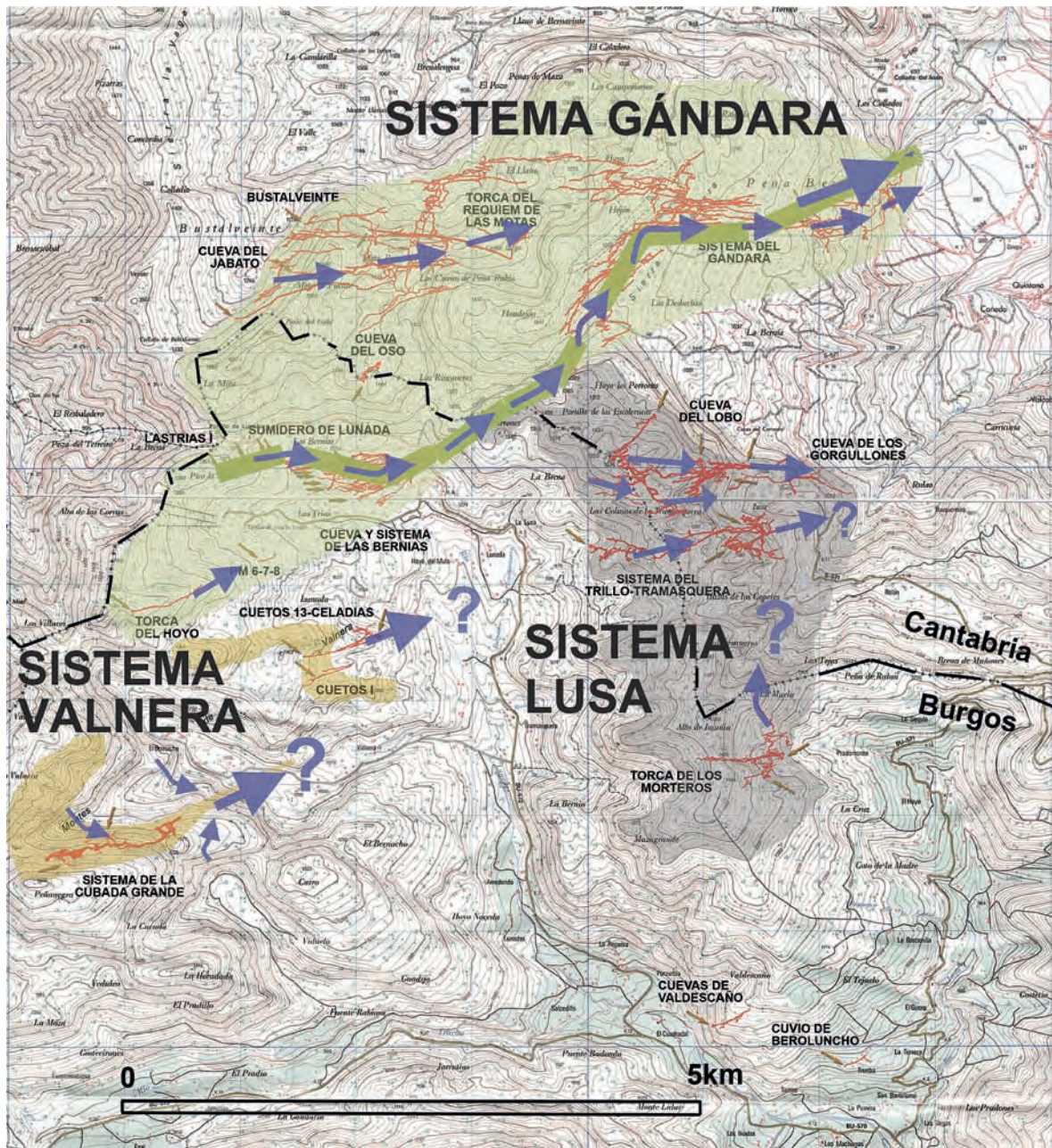
Principales redes espeleológicas y cavidades de los Montes de Valnera y su relación con los sistemas hidrogeológicos. (Montaje topográfico sobre MTN25: Miguel Rioseras)
