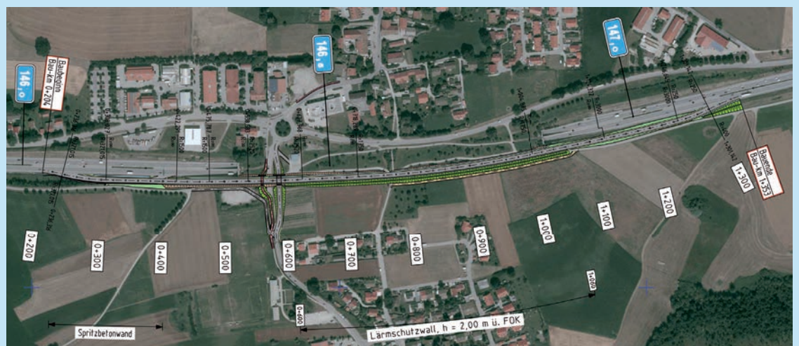
Provisorische Umfahrung beim Tunnel Etterschlag
