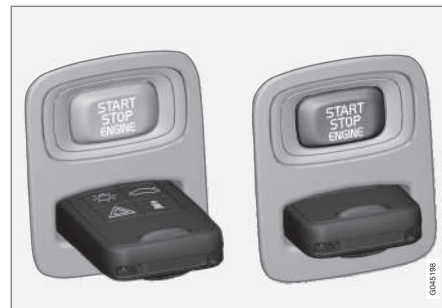
Zündschloss mit herausgezogenem/eingedrücktem Transponderschlüssel.
