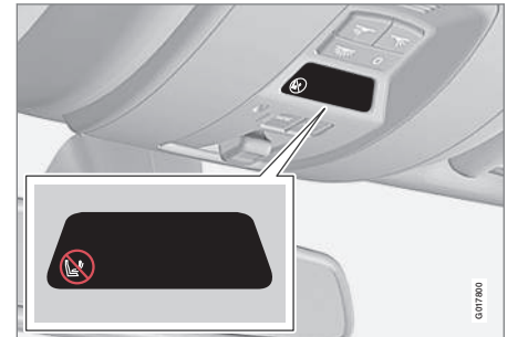
Anzeige, die darauf aufmerksam macht, dass der Beifahrerairbag aktiviert ist.
