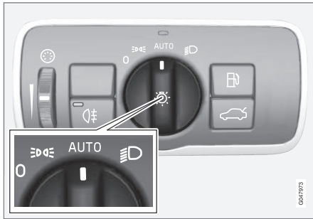
Drehregler des Lichtschalters in Stellung AUTO .
