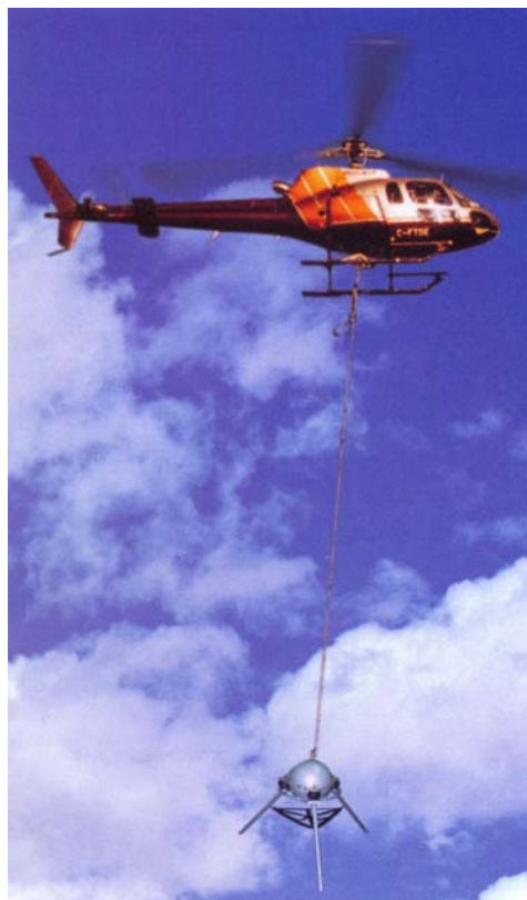
Figura 3.11 - Prospección gravimétrica desde un helicóptero
