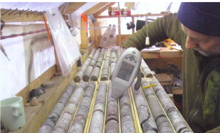
Figura 3.15: Testigos de perforación analizados en el campamento con un equipo portátil de análisis por fluorescencia de rayos x.
