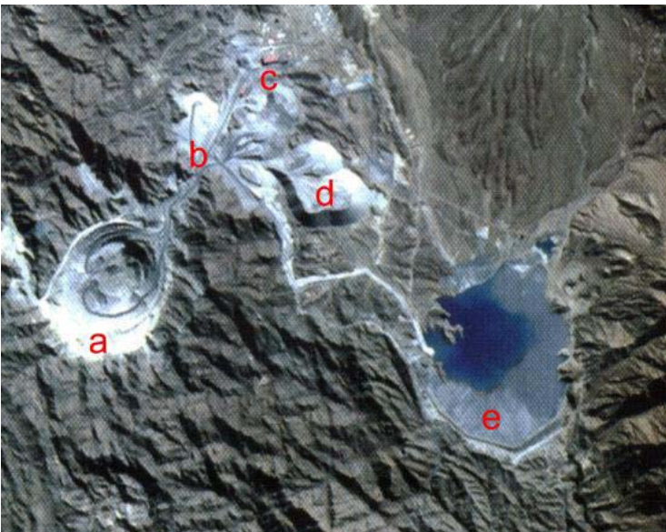
Figura 1.24: Imagen satelital Aster del establecimiento minero industrial Bajo de la Alumbraera. A la izquierda (a) está la mina a cielo abierto (llamada open pit, en inglés), un poco más arriba se observa la cinta transportadora y el sector de almacenamiento (b) de mineral para alimentar a la planta (c). En el centro de la imagen se ven las escombreras (d) y a la derecha está el dique de colas (e).
