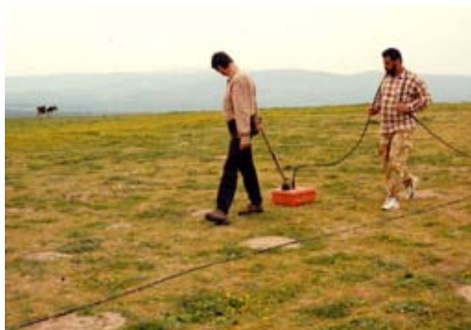
Abbildung 3.1: Georadarmessung auf dem 20 ha großen Siedlungshügel Tell Gjindaris in Syrien. Foto: Fa. eastern atlas, Berlin, NTG-Vorhaben 03SUX4KN.
