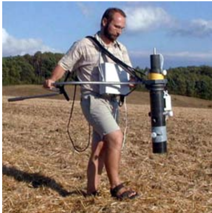
Abbildung 7.2: Prototyp eines Hochtemperatur-SQUID-Gradiometers, das derzeit für den mobilen Einsatz optimiert wird. Das Hauptaugenmerk liegt dabei bei der mechanischen Stabilität.
