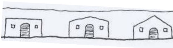
Schildmauern mit geradem, flachen und steilem Abschluss
