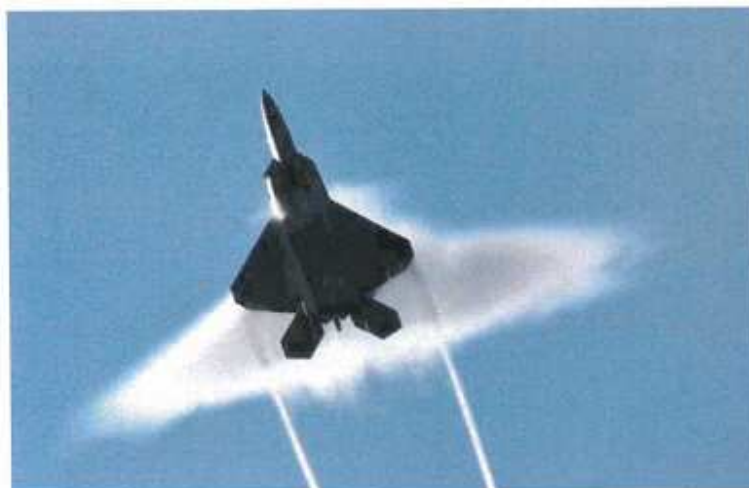
Un 'Raptor' F-22 de l'US Air Force exécute un survol à basse altitude produisant des vortex et un 'shock egg'. 3
