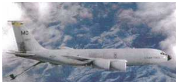
L'avion citerne KC 135 st une version militaire du Boeing 707 équipé de moteurs JT 3D -3B ,testés entre 1972 et 1974. Une autre version, le E - 3 Sentry mieux connu sous le nom AWACS ( Airborne Early Warning & Control System ) est équipé de TF33 - PW100A d'Inter Turbine Technologies et ne sont pas repris dans la Banque des données de l'OACI. 27
