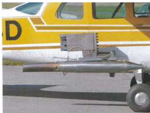
Cesna avec un dispositif d'ensemencement de nuage avec de l'iodure d'argent
