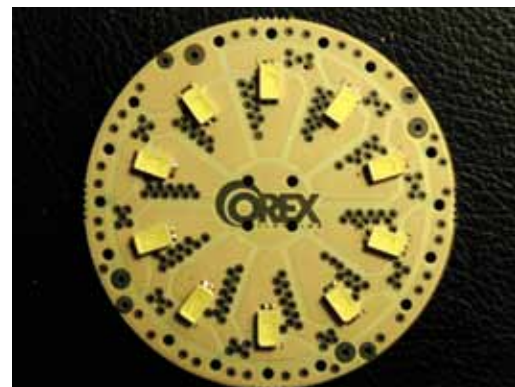
LED-матриця без радіатора
