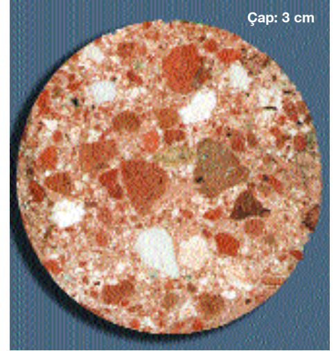
Şekil 1. Ördekli Hamamı sıcaklık mekânında kullanılan Horasan sıvanın dokusu. Figure 1. The texture of the Horasan plaster used in the caldarium of Ördekli Hamam.
