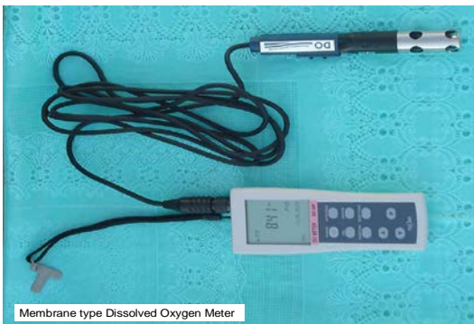
Fig 8. Membrane type DO meter
