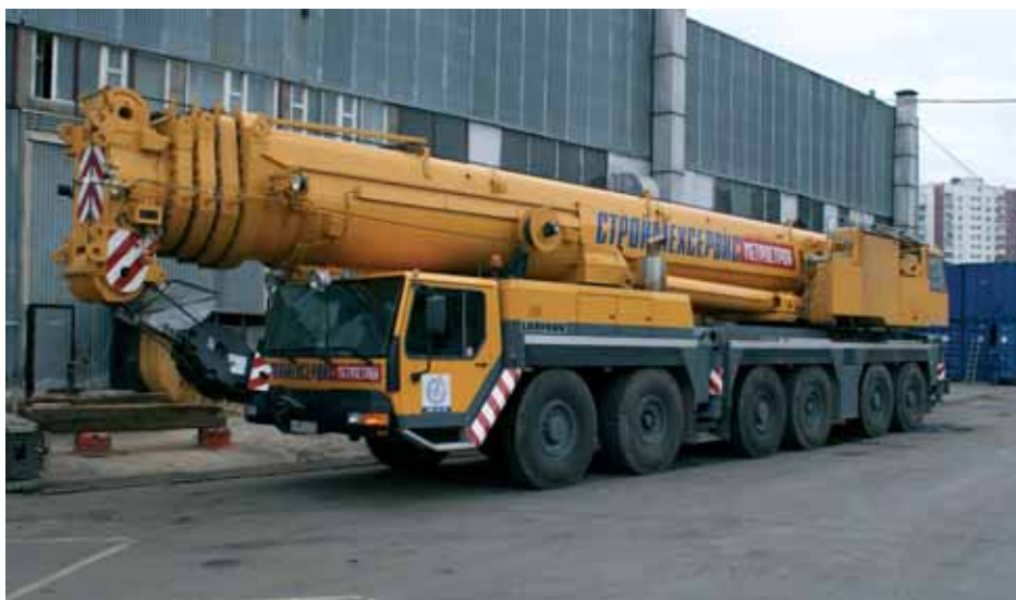
Краны на спецшасси фирмы «Liebherr» LTM 1300 грузоподъемностью 300 т
