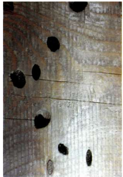
РИС. 29-30. УСАЧ ЧЁРНЫЙ СОСНОВЫЙ: Личиночный ход под корой на поверхности древесины (29) и в древесине (вид на спиле, 30). Ориг.
