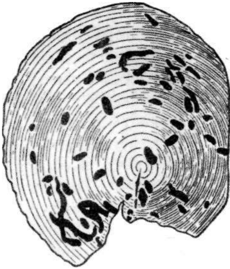
Рис. 26. ДРЕВЕСИНА, ПОВРЕЖДЁННАЯ ЛИЧИНКОЙ HYLOTRUPES BAJULUS (по Воронцову, 1995).
