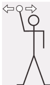
Krátke vodorovné pohyby ručným lampášom s bielym svetlom vzpaženej ruky
