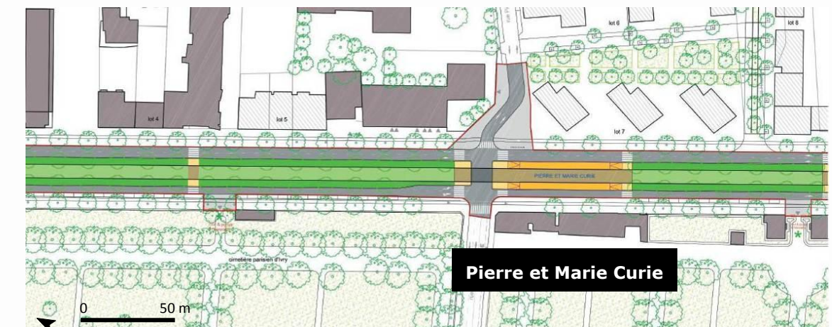
Figure 35 : Plan de l’insertion du tramway le long du cimetière parisien à Ivry-sur-Seine
