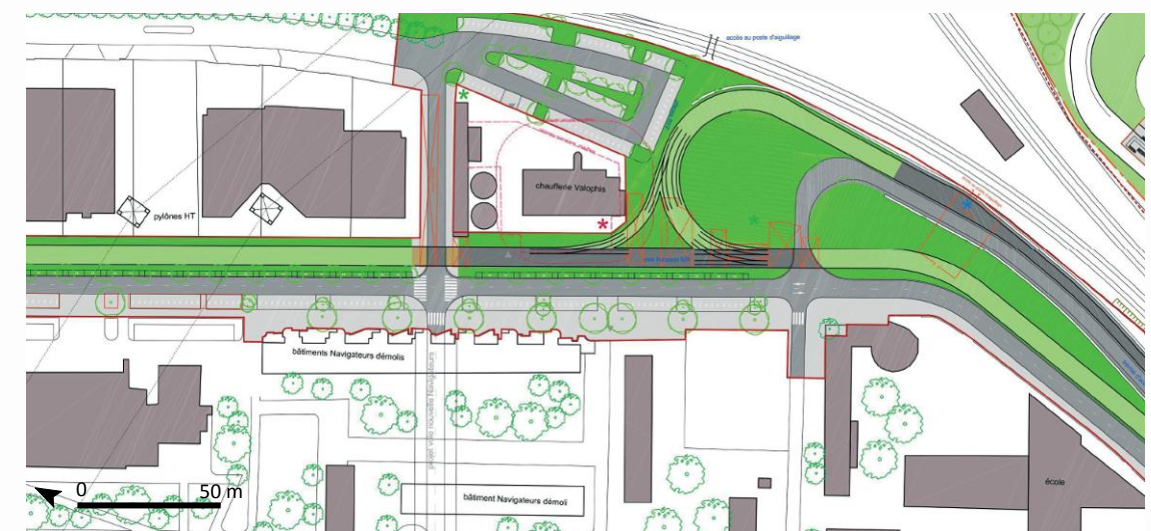
Figure 63 : Plan de l'insertion du tramway au niveau du raccordement à la ligne de la voie d'accès au site de Maintenance et de Remisage
