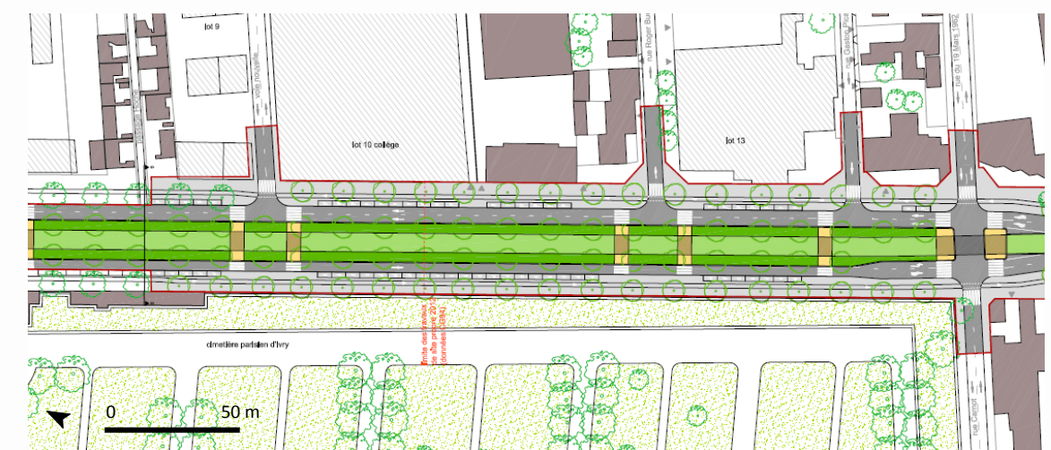
Figure 36 : Plan de l’insertion du tramway entre le passage Hoche et la rue du 19 mars 1962
