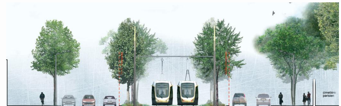
Figure 32 : Coupe type des aménagements sur le nord d'Ivry-sur-Seine
