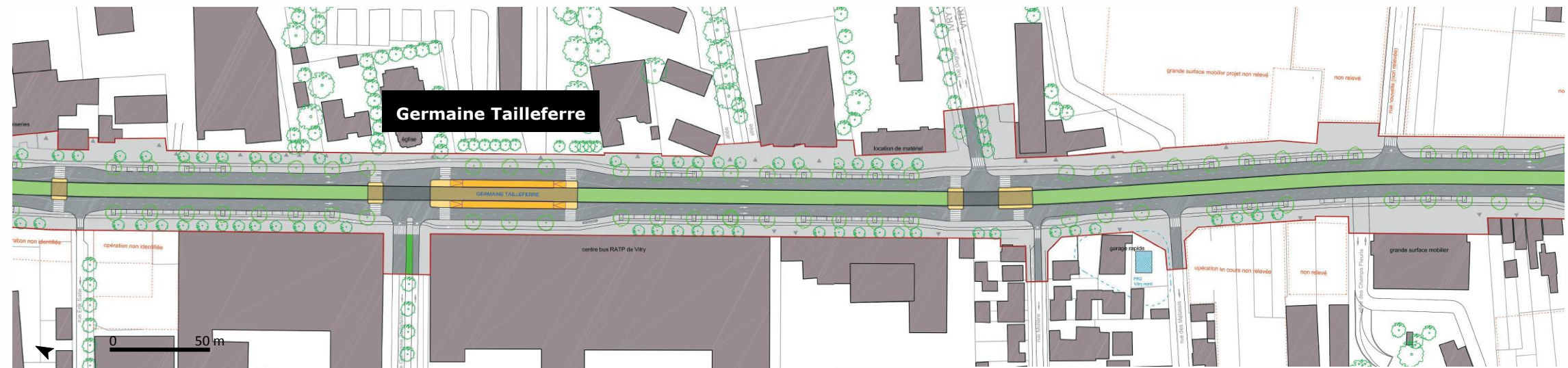
Figure 40 : Plan de l'insertion du tramway sur le boulevard Stalingrad
