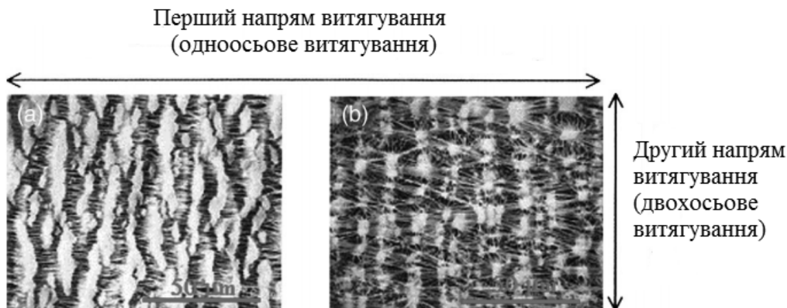
Рис. 5. Одноосьове та двохосьове витягування полівініліденфлуоридної мембрани методом розтягування
