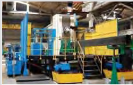
Специальный продольный фрезерно-расточный станок мод. МСП6401МФ4-04С (МЗОР)
