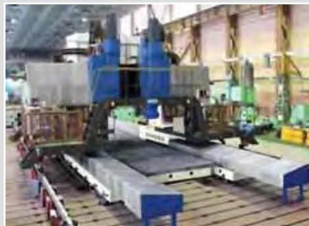
Специальный продольный фрезерно-расточный станок с ЧПУ и УАСИ мод. МС620ГМФ4-16Б2 (МЗОР)
