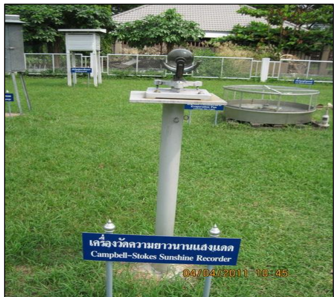
เครื่องวัดแสงแดดแบบ Campbell-Stoke
