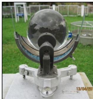
เครื่องวัดแสงแดดแบบ Campbell-Stoke
