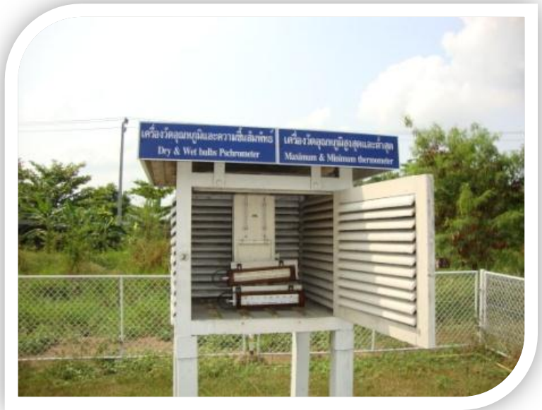
เรือนเทอร์โมมิเตอร์ (ตู้สกรีน) เครื่องวัดอุณหภูมิสูงสุด & ต่ำสุด เครื่องวัดอุณหภูมิความชื้นสัมพัทธ์
