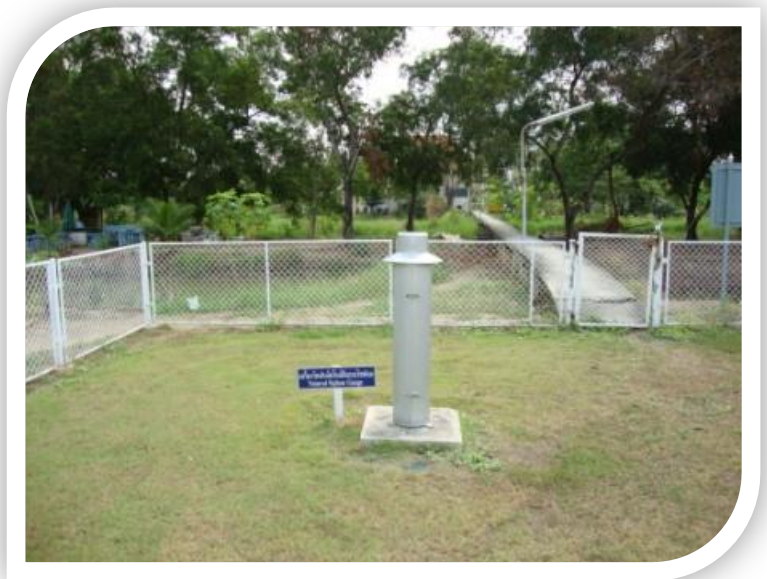
เครื่องวัดฝนอัตโนมัติแบบไซฟอน (Natural Siphon Gauge)
