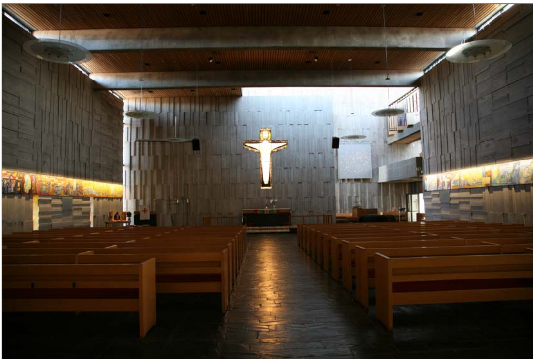
Högsbo kyrka har en klerestorielik fönsterkrans utmed takfoten och asymmetriskt dolda sidoljus i koret.
