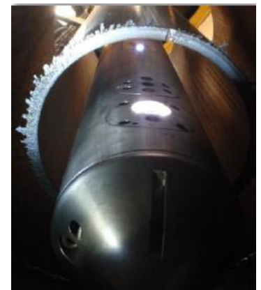
Extrémité d'ELOÏSE avec ses 2 caméras (bouchons éclairés) et la buse de la tête laser (bouchon non éclairé)
