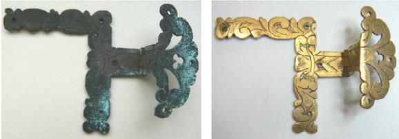
Ein Scharnier vor und nach der Entfernung der Korrosionsprodukte und galvanischen Vergoldung.
