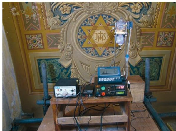
**Fig.1** O sistema portátil de EDXRF posicionado para a medida de uma região da pintura mural, montado sobre um andaime no topo de uma das capelas da igreja.
