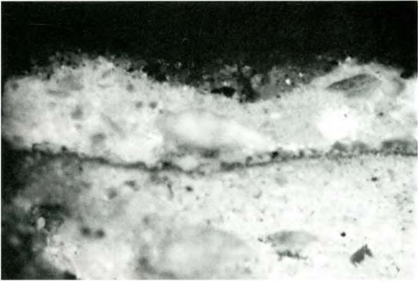
Foto 12- Estratigrafia d'una mostra pigment (Eudal Cid, arxiu CRBMC)
