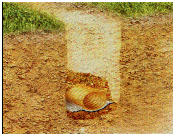
45 pav. Drenazo vamzdžio paklojimo pavyzdys
