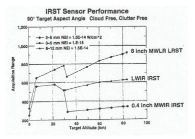
Figure 12. IRST Sensor Performance<sup>67</sup>
