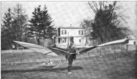
Herring's Kunstflugmaschine vom Jahre 1894 mit vorn befindlichem verstellbarem Horizontalsteuer.
