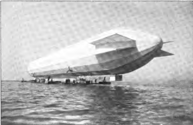
Das Luftschiff mit den Schwanzflossen zur Sicherung der Stabilität.
