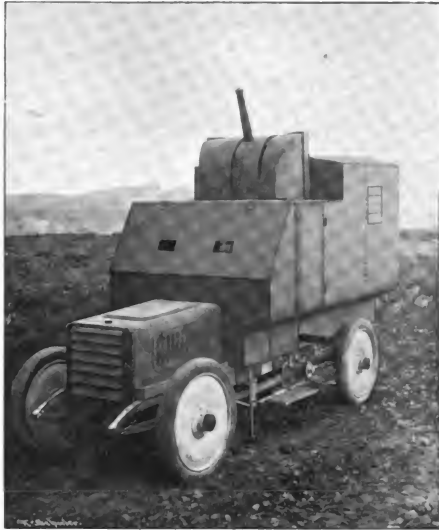
Fig. 1. Ehrhardt's Panzerautomobil mit Schnellfeuergeschütz zur Verfolgung und Bekämpfung lenkbarer Luftschiffe.
