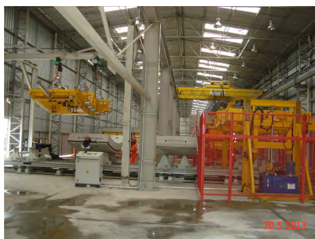
Fábrica de Anéis do Shield - Lote 7: Fabricação dos anéis
