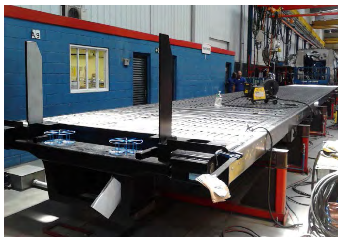
Montagem da caixa dos Carros B: fixação da estrutura suporte do piso no estrado.
