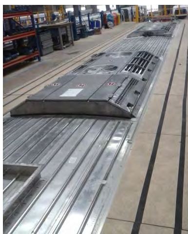
Detalhe do ar condicionado do Carro A1 do 1º trem.
