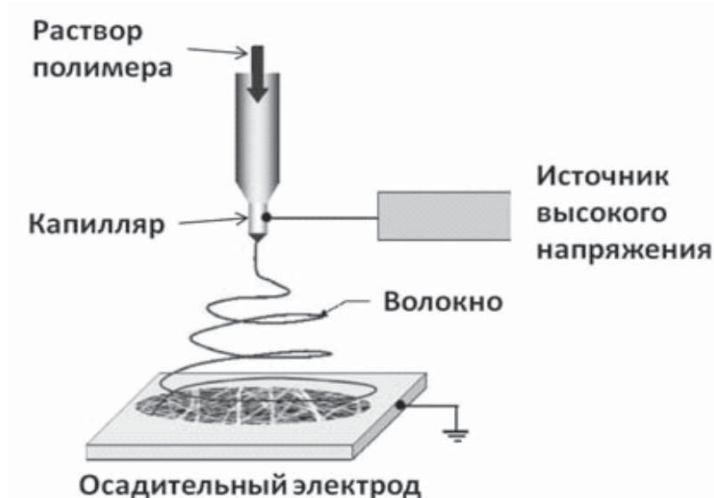
Рис. 1. Процесс электроформирования нановолокна из раствора полимера
