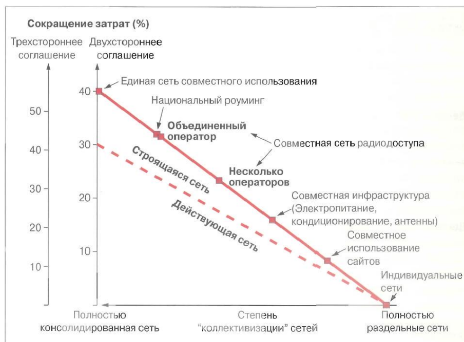
Рис. 1. Потенциальное сокращение затрат в результате совместного использования сети в зависимости сценария и количества операторов-партнеров
