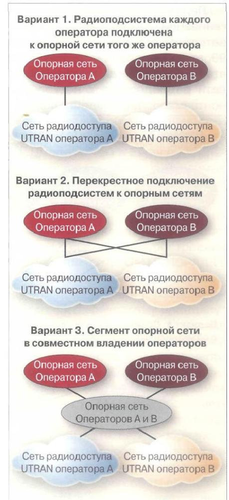
Рис. 6. Три варианта построения совместной сети с разделением по географическому принципу
