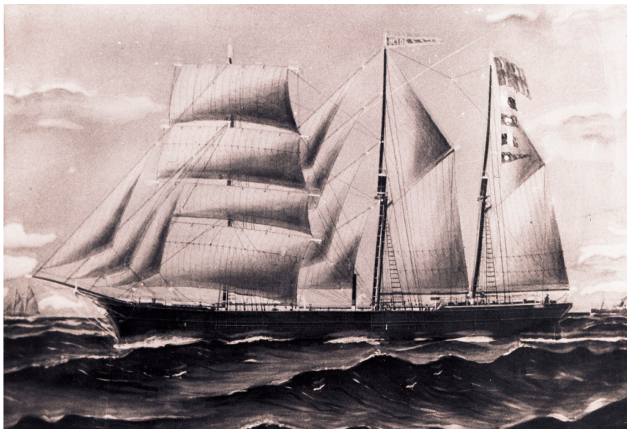
Barken Heidi, här omriggad till brigantin, levererades från Gamla Varvet år 1864 till G Melin, Göteborg. Hon mäter 650 ton.
