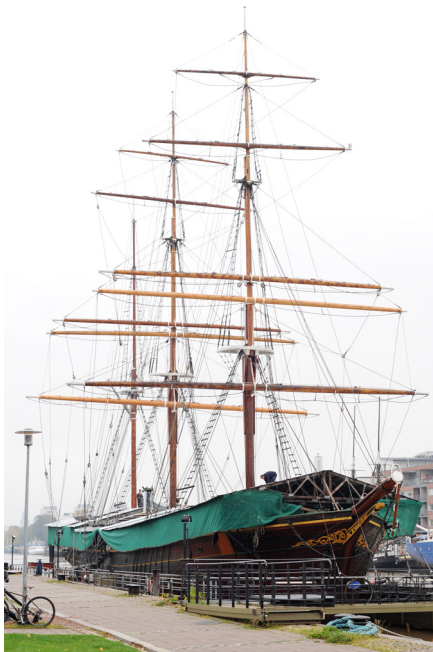
Sigyn under renovering år 2012. Hon ligger i flytdocka i Aura å, vintertid är däcket täckt av pressen- ingöverbyggnad.
