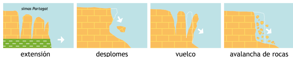
12 figura 8 - Esquema de los diferentes mecanismos de rotura existentes en el frente N de la Sierra de Aitana.
