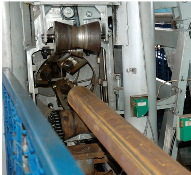
Выявление поперечных дефектов трубы
