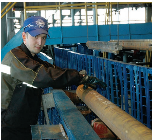
Проверка кривизны трубы
