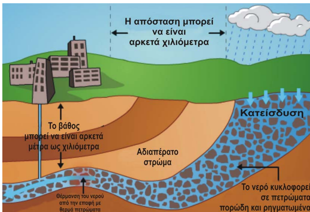
Εικόνα 6: Απλοποιημένη λειτουργία ενός γεωθερμικού πεδίου
