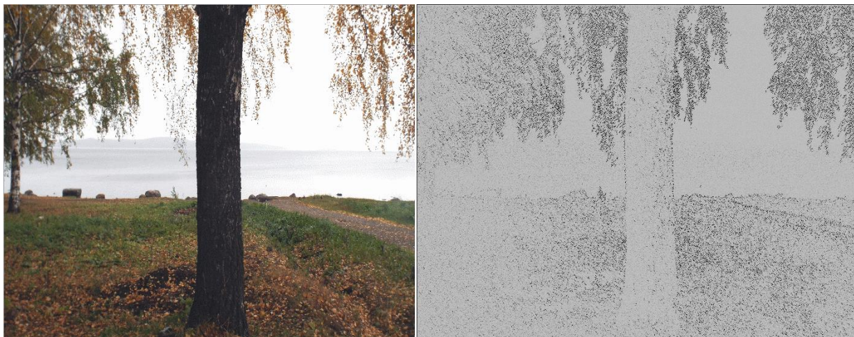
Рисунок 1 – Применение оператора Собеля для выделения границ ствола дерева.
