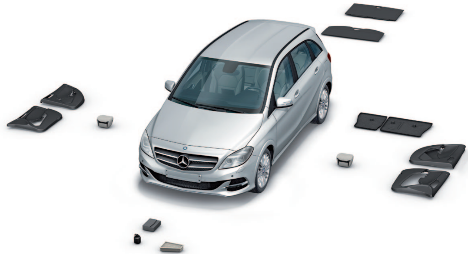
Abbildung 2-13: Bauteile aus nachwachsenden Rohstoffen in der B-Klasse Electric Drive
