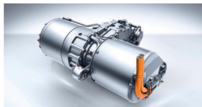
Das Batteriepaket ist platzsparend im Energy Space unter dem Wagenboden angeordnet, die elektrische Antriebseinheit wurde im unveränderten Motorraum untergebracht. Der 132 kW starke Elektromotor treibt die Vorderräder an
