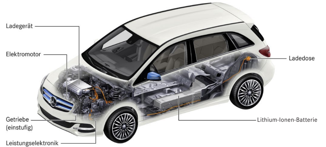
Abbildung 2-1: Elektroantriebskomponenten B-Klasse Electric Drive
