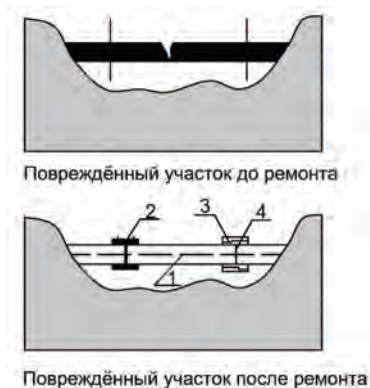
Рисунок 1. Ремонт трубопровода из армированных полиэтиленовых труб
