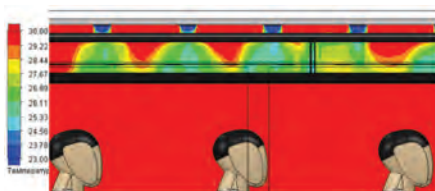
Рисунок 7 – Влияние расположения багажных полок на распределение охлажденного воздуха в салоне автобуса
