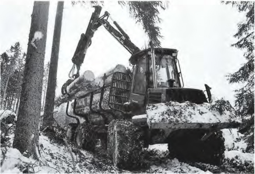
«Forwarder» sind die neuen Rückefahrzeuge, die in befahrbarem Gelände die abgelängten Stämme an die Abfuhrwege befördern. (Fotos: Forstbetrieb Sigriswil)
