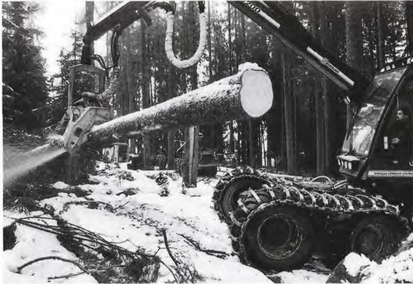
Als Folge von «Lothar» hat im Schweizerwald ein grosser Mechanisierungsschub stattgefunden: «Vollernter» (Harvester) entasten die Stämme und zerschneiden sie auf gewünschte Längen. (Fotos: Forstbetrieb Sigriswil)
