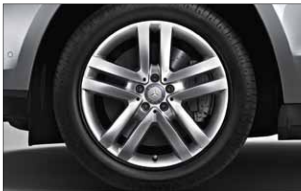
Легкосплавные диски с 5 двоянными спицами, шины 275/55 R 19 (опция, серийно для GL 500 4MATIC, код R55).
