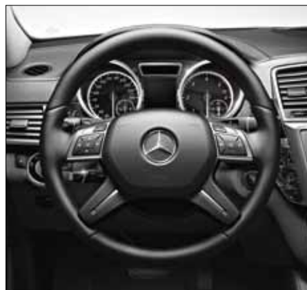
Обтянутый кожей наппа multifункциональный руль с 12 кнопками и переключателями передач.
