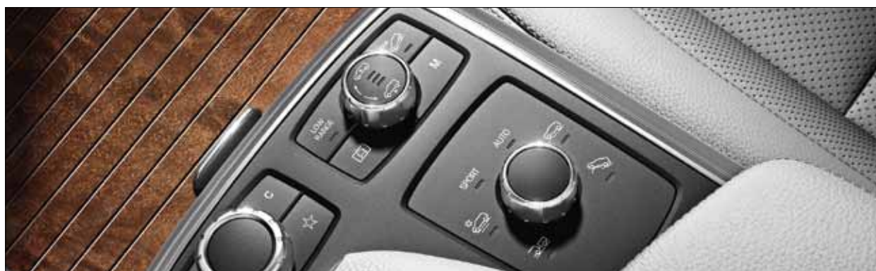
При помощи поворотного переключателя на центральной консоли выбирается необходимая программа движения.
