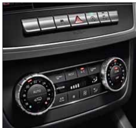
Двухзонный автоматический кондиционер THERMATIC.
