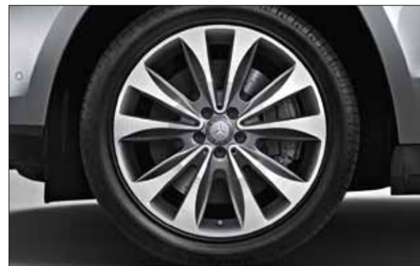
Полированные легкосплавные диски с 10 спицами, шины 275/50 R 20, цвет «Серые Гималаи» (опция, код 50R).
