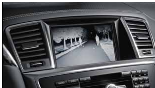
Специальная маркировка на дисплее системы ночного видения Plus позволяет лучше распознавать пешеходов.
