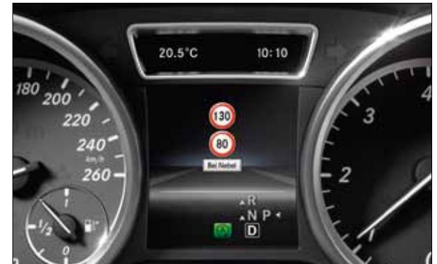
Система контроля за ограничениями скорости выводит на комбинацию приборов также временные ограничения скорости.
