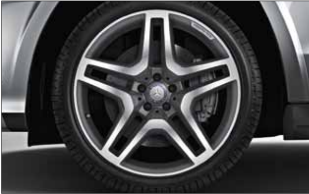
Полированные легкосплавные диски AMG с 5 двоянными спицами, шины 295/40 R 21 (серийно для спорт-пакета AMG «Экстерьер», код 757).
