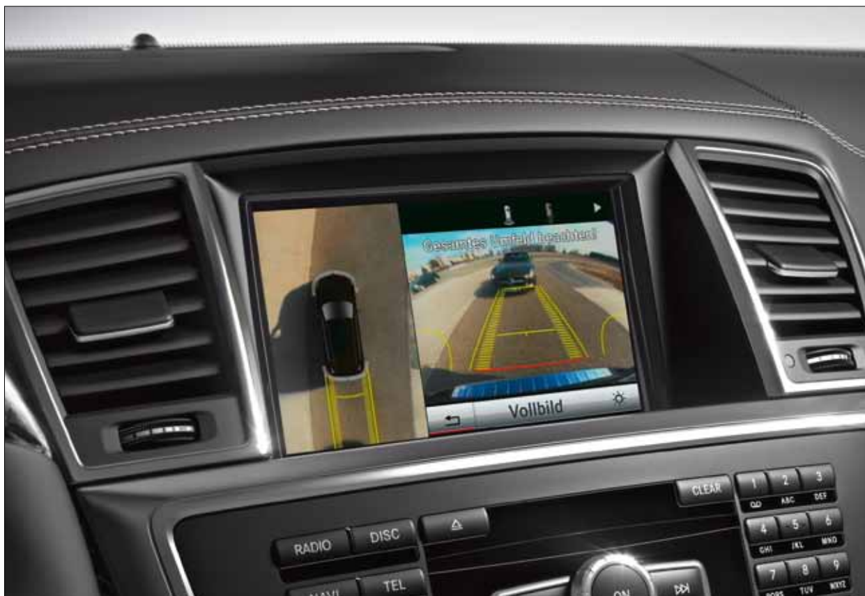
Видеокамера кругового обзора передает изображение зоны вокруг GL-Класса с высоты птичьего полета.
