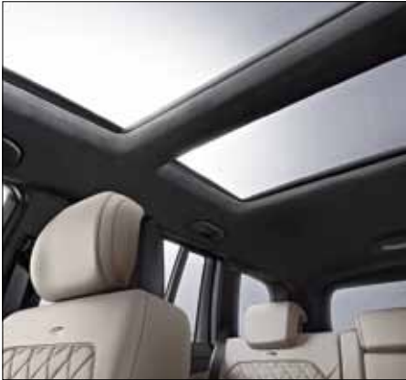
Панорамная сдвижная крыша с электроприводом, стеклянная.
