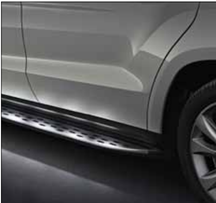
Подножки под алюминий, с резиновыми шипами и светодиодной подсветкой (серийно для GL 63 AMG).
