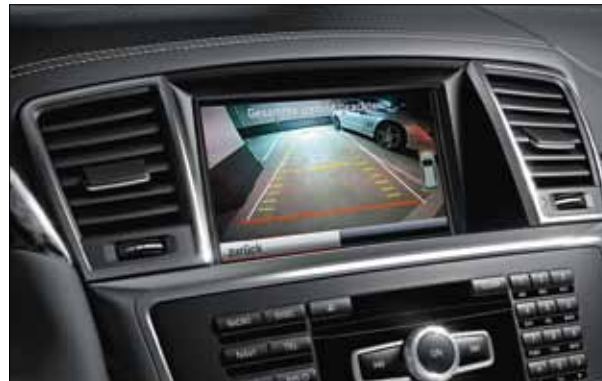
Во время парковки видеокамера заднего вида передает изображение зоны за автомобилем на центральный дисплей системы COMAND Online.
