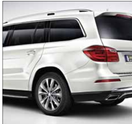
Начиная со средней стойки – сплошное термопоглощающее остекление с темной тонировкой.
