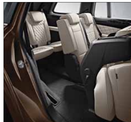
Система EASY-ENTRY: механическое откидывание, слева и справа для сидений 3-го ряда.
