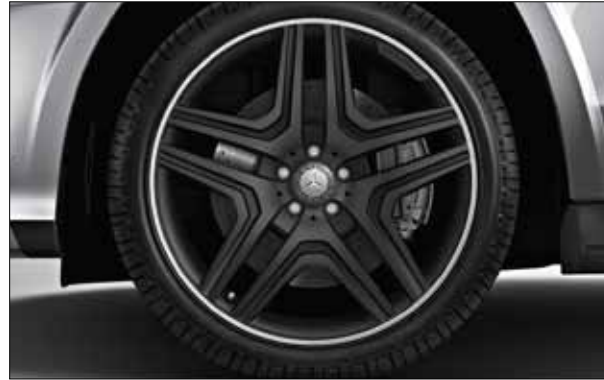
Легкосплавные диски AMG с 5 двоянными спицами, матово-черная лакировка, шины 295/40 R 21, полированный обод (опция, код 695).
