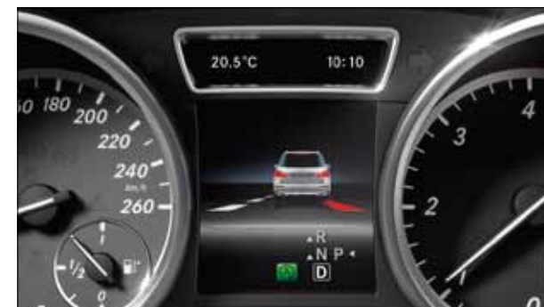
Предупреждает о пересечении дорожной разметки и возвращает автомобиль на полосу движения: активная система удержания полосы движения.
