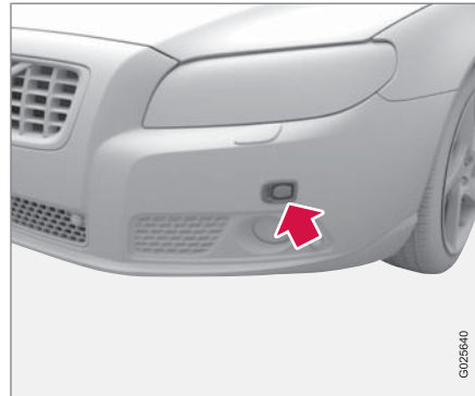
Steckdose für Motorheizung.
