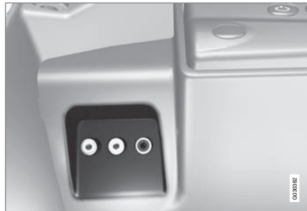
Der RSE-AUX-Anschluss befindet sich unter der vorderen Armlehne.
