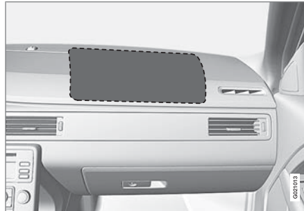
Position des Beifahrerairbags in Linkslenkern.
