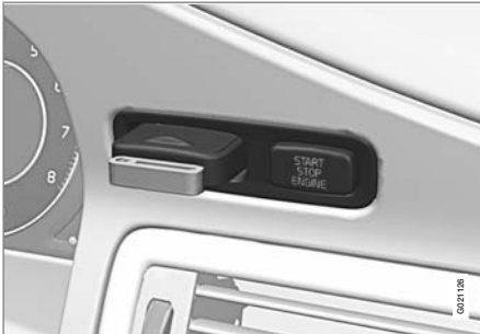
Zündschloss mit eingezogenem Transponderschlüssel und START/STOP ENGINE -Taste.
