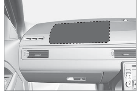
Position des Beifahrerairbags in Rechtslenkern.
