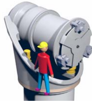
1.5-MW MS-1 drivetrain
